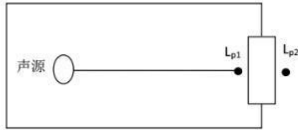
图 5.5-1 室内声源等效为室外声源示意图
