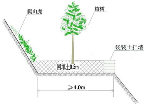
图 5-10 台阶复垦设计示意图
