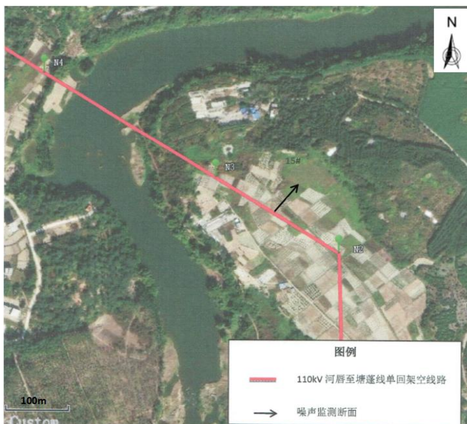
图 4.3-2 110kV 河唇至塘蓬线单回架空线路布点示意图
