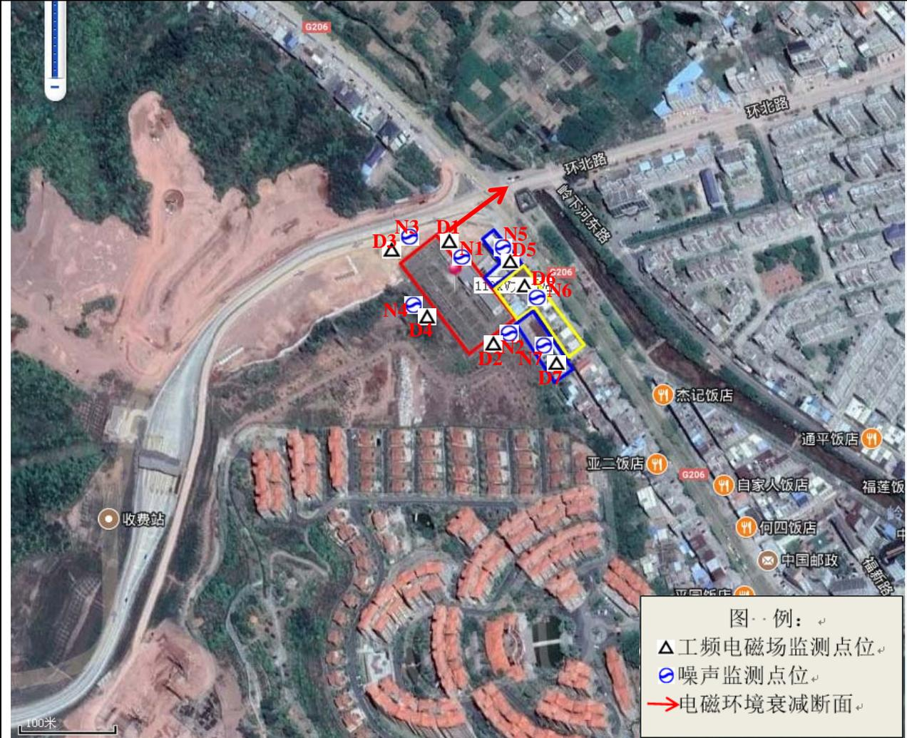
附图 3 梅州平远 110 千伏大柘站扩建第二台主变工程监测布点示意图
